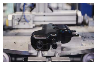
Bearbetningscell för styrservo-behållare i polyamid.
