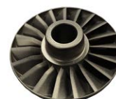
3D-printad detalj i verktygsstål till fordonsindustrin.
