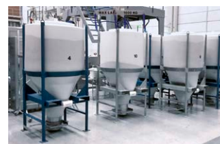
Doseringssilo i livsmedelsgodkända och återvinningsbara material.
