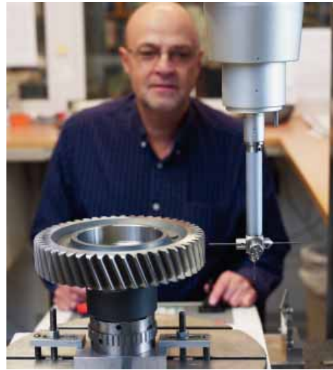
Verifiering av kuggdata på kuggjul hos Mikroverktyg. Här spelar en tusendels millimeter roll för att undvika att missjud uppstår i slutprodukten.
