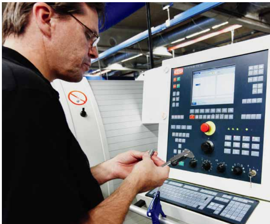
En detalj granskas inför produktionsstart i Segerströms CNC-styrda långdsvarv.
