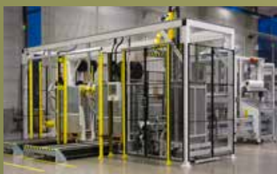
Palleteringsmaskin för lock.
