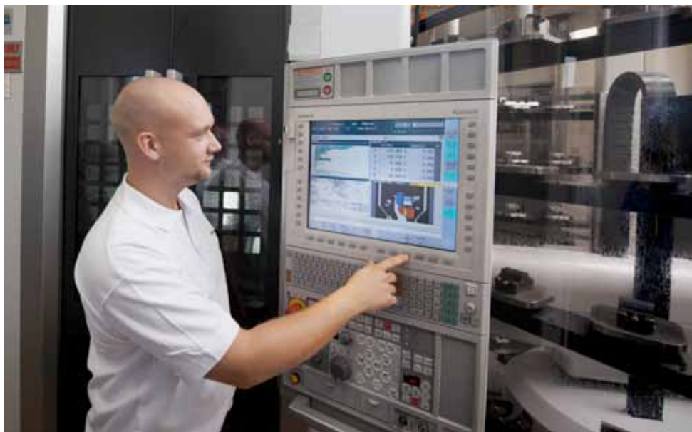
Produktion i helautomatisk sexaxlig bearbetningscell hos Fredriksons.
