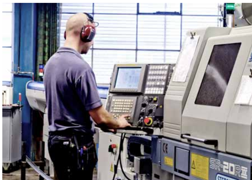
CNC-styrd längdsvärv anpassad för bearbetning av långa detaljer.
