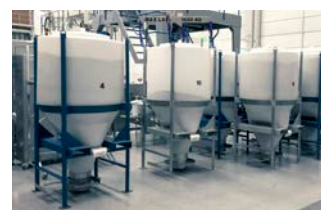
Doseringssilo i livsmedelsgodkända och återvinningsbara material.
