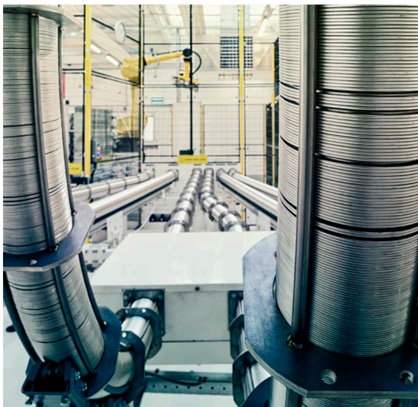
Modul i en produktionslinje där Canlines transportörsystem matar burklock in i NPBs balanserare.
