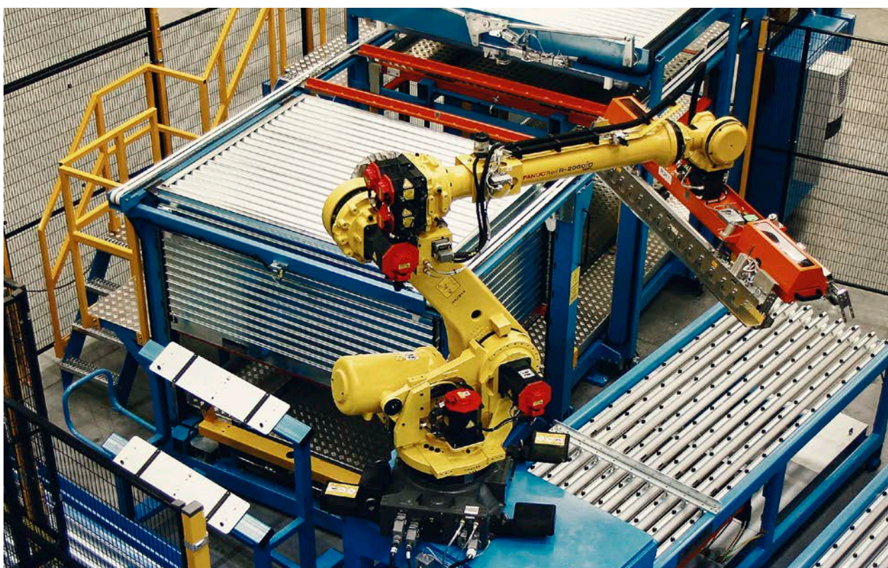
NPB utvecklar hanteringslösningar till förpackningsindustrin. Utrustningen ovan balanserar flödet av lock till dryckesburkar i en produktionslinje.
